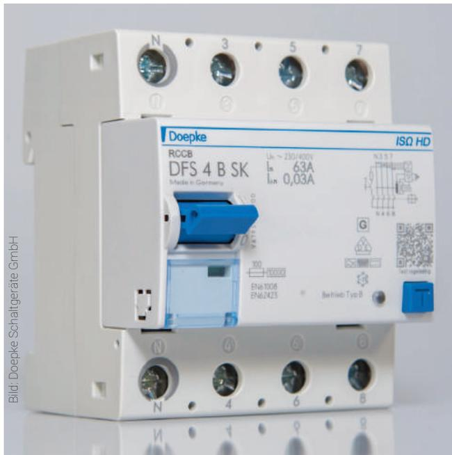
**Bild 2** | Mit der Ausführung ISQ HD gibt es jetzt allstromsensitive Fehlerstrom-Schutzschalter, die Isolationsprüfungen ohne vorheriges Abklemmen möglich machen.
