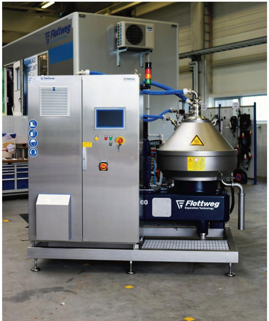
Für kleinen Bauraum geeignet: Industriezentrifuge und Steuerungselektronik als Kompaktanlage
