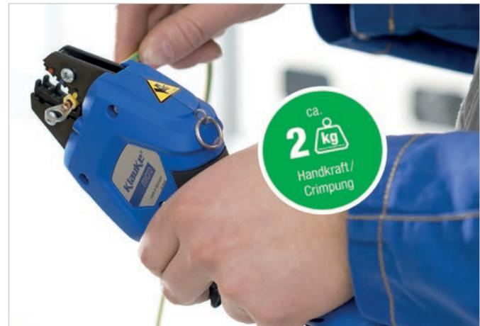
Bild 4 | Bei Verwendung der elektromechanischen Crimpzange Klauke Micro liegt die Handkraft pro Crimpung bei lediglich 2kg.
