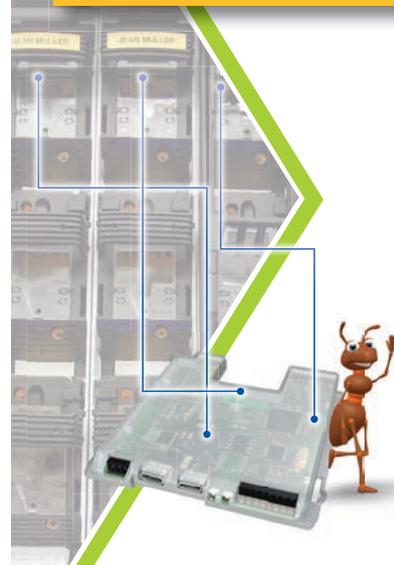
PLPlano, das kleinste, intelligente Energie-Monitoring-Modul für NH-Sicherungslastschaltleisten, sorgt für mehr Transparenz in Niederspannungsverteilernetzen oder in der Verbraucheranlage.
