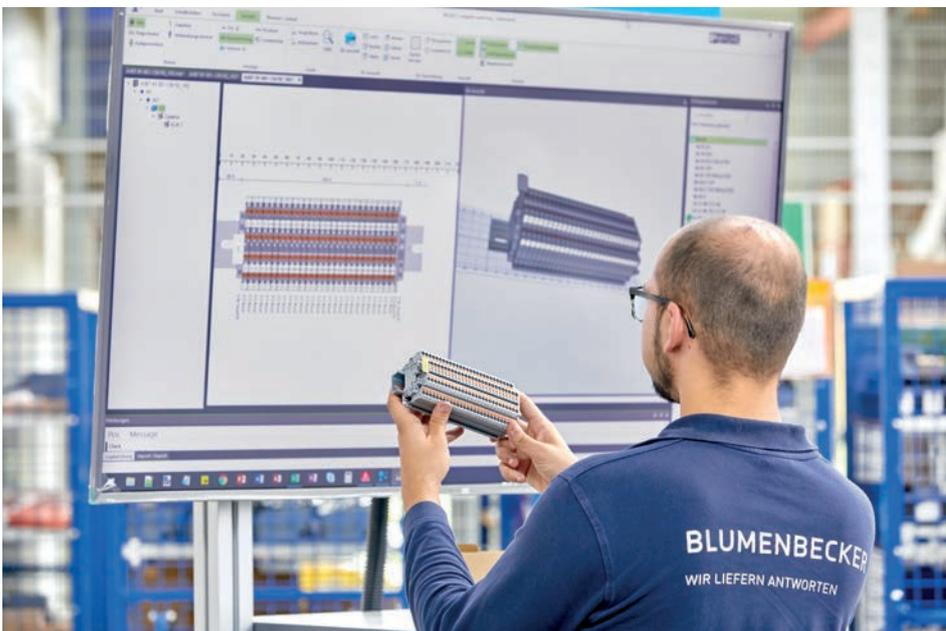
**Bild 3** | Aus digital wird real: die soeben bestückte Tragschiene wird mit dem digitalen Abbild in der Planungssoftware Project Complete abgeglichen.
