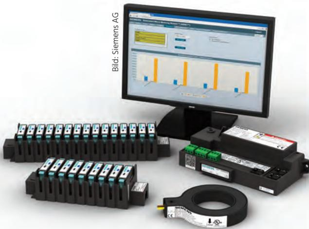
Bild 5 | Das Messsystem SEM3 wird in der Energie-Hauptverteilung eingesetzt und besteht aus Stromwandlern, Messmodulen und einem zentralen Controller. Das skalierbare Komplettsystem kann bis zu 45 Messpunkte im Gebäude erfassen.
