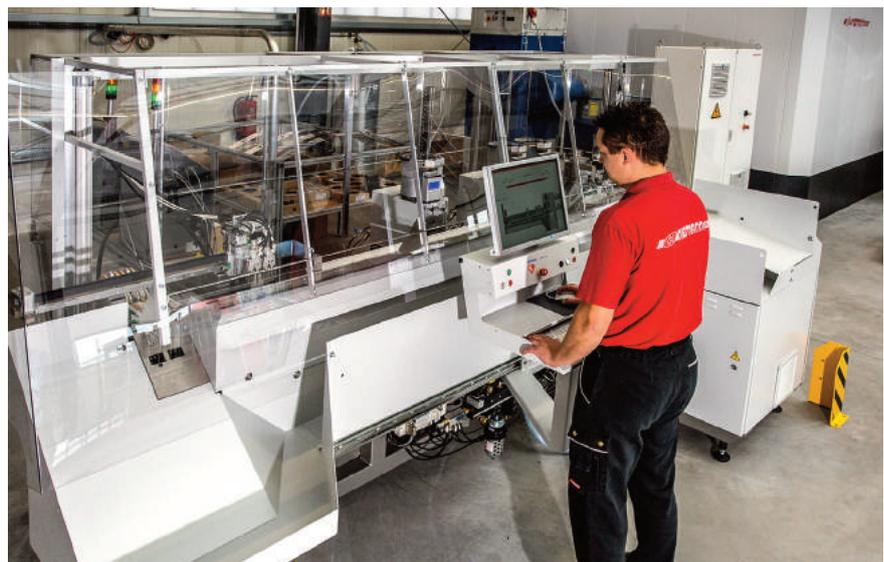
**Bild 4** | Für die Herstellung der Drähte und Drahtsätze hat die Firma NW-Niemann in ein NC-Bearbeitungszentrum investiert – die Daten dafür kommen direkt aus dem mit der WSCAD Suite erstellten Schrankaufbau.
