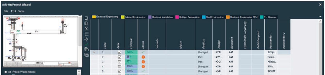
Bild 3 | Die Daten für Stromlaufpläne, Schrankaufbauten und Dokumentation werden bei BSG aus dem Angebotssystem über einen haus-eigenen Konfigurator nach WSCAD übernommen und dort automatisch generiert. Die Zeitersparnis im Engineering beträgt bei Standardsteuerung 80 bis zu 90 Prozent.
