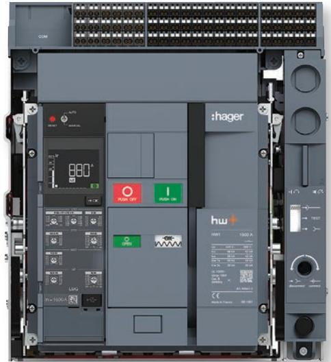
Bild 3 | Der offene Leistungsschalter HW1 in Festeinbau- und Einschubtechnik ist als 3- und 4-polige Ausführungen in Nennströmen von 630 bis 1.600A und mit Ausschaltvermögen von 42, 55 und 66kA verfügbar.
