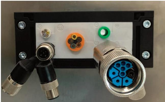
Bild 3 | Installierter, bestückter Klemmrahmen KR24 mit zehn Rastereinheiten
