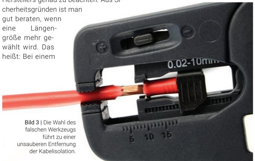
Bild 3 | Die Wahl des falschen Werkzeugs führt zu einer unsauberen Entfernung der Kabelisolation.
