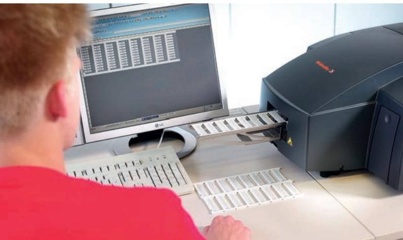
**Bild 4** | Automatisierte Plottstationen entlasten die Mitarbeiter bei der Beschriftung der einzelnen Bauteile.
