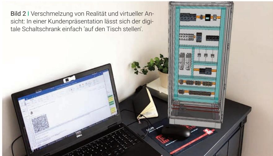
**Bild 2 |** Verschmelzung von Realität und virtueller Ansicht: In einer Kundenpräsentation lässt sich der digitale Schaltschrank einfach 'auf den Tisch stellen'.
