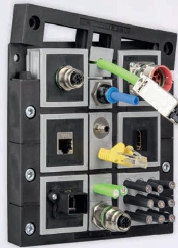
IMAS-CONNECT™ ist ein modulares Adaptertüllensystem zur Aufnahme von Keystone-Modulen, PushPull Anbaugehäusen, Rundsteckverbindern, Schlauchverschraubungen, Druckausgleichselementen u.v.m.
