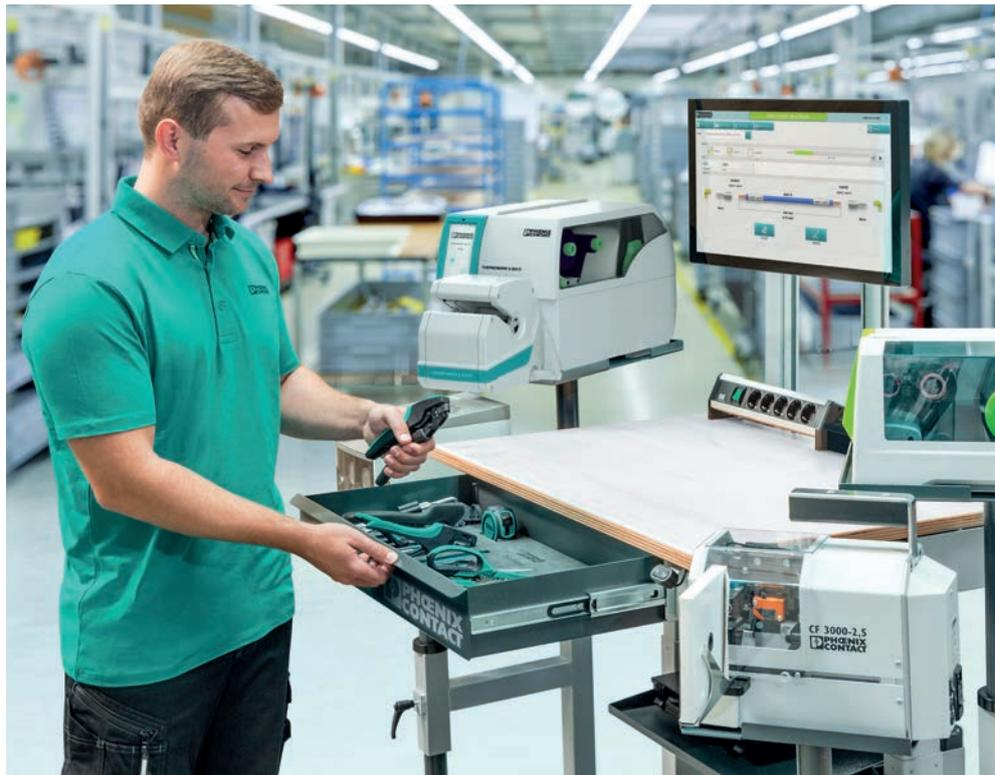
**Bild 4 |** Das Werkerassistenz-System Clipx Wire Assist ist eine modulare Arbeitsplatzlösung für alle Prozesse der Leitervorbereitung.
