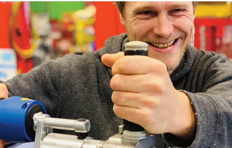
**Bild 3 |** Angetan sind die Monteure auch von dem akkubetriebenen Ausklinkwerkzeug, mit dem sich auch bereits montierte Kabelkanäle einfach bearbeiten lassen.
