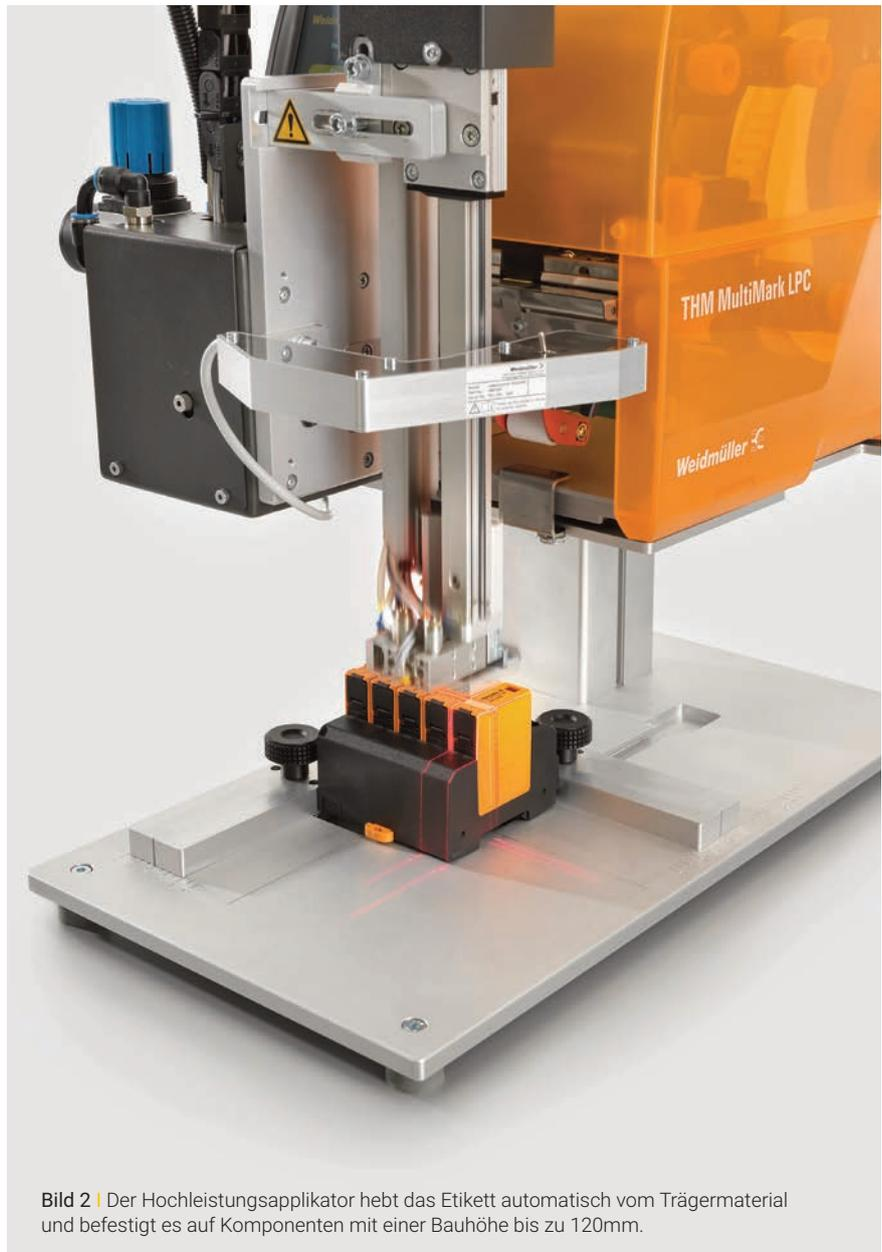
**Bild 2** | Der Hochleistungsapplikator hebt das Etikett automatisch vom Trägermaterial und befestigt es auf Komponenten mit einer Bauhöhe bis zu 120mm.
