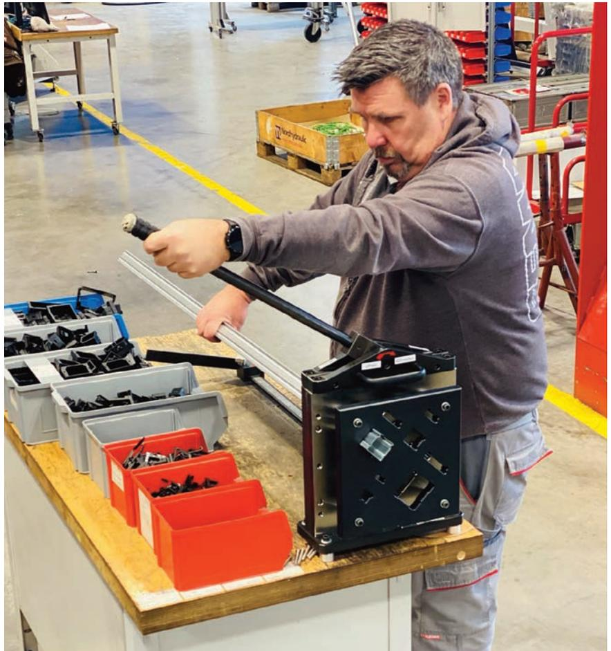
**Bild 4 |** Auf einer mobilen Werkbank hat Sema die MiniCut installiert, so dass der Monteur vor Ort die Kabelkanäle in kürzester Zeit konfektionieren kann.
