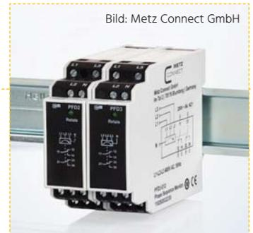
Das Drei-Phasenüberwachungsrelais überwacht die richtige Phasenfolge und die einzelnen Phasenspannungen sowie die angeschlossenen Nullleiter auf Totalausfall.
