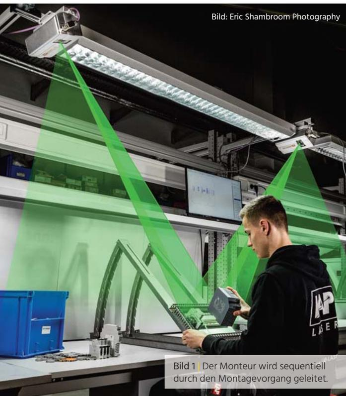
Bild 1 Der Monteur wird sequentiell durch den Montagevorgang geleitet.
