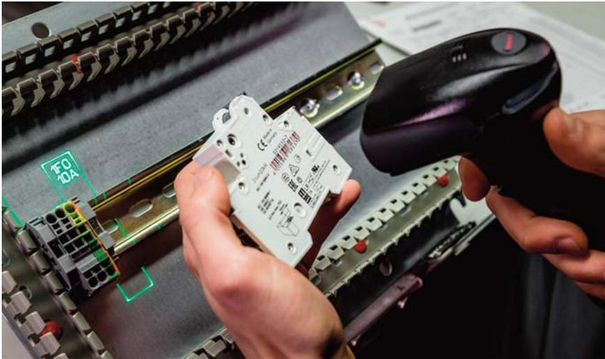
Bild 4 | Mittels Barcode-Scanner wird die zugehörige Bauteilposition aufgerufen.
