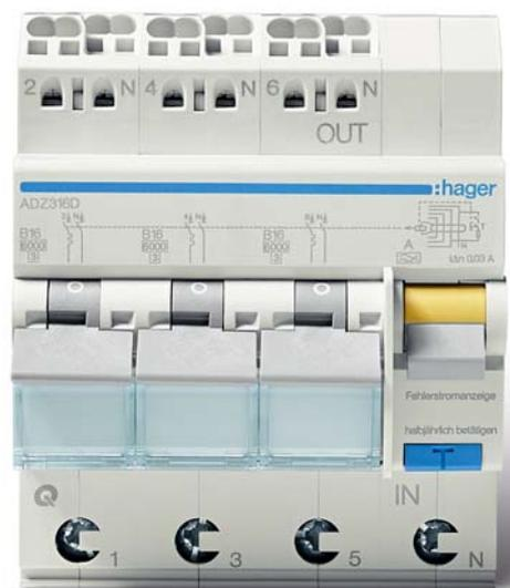
**Bild 3 |** Der FI/LS-Schalter 3x1-polig+N verbindet drei einpolige Leitungsschutzschalter für drei 230 V-Wechselstromkreise mit einem FI-Schalter, der alle drei Stromkreise gleichzeitig sichert.
