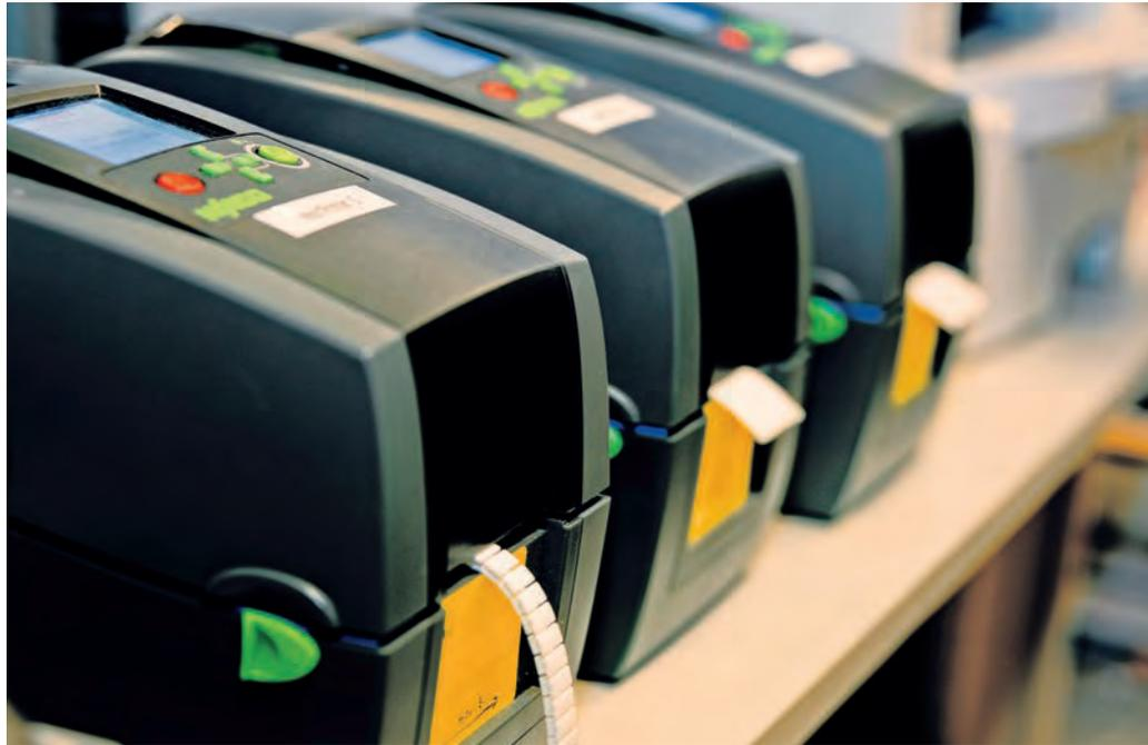
**Bild 2** | Die Schnittstelle zwischen den Wago Druckern und dem Smart Designer erleichtert die Beschriftung von Klemmenleisten.
