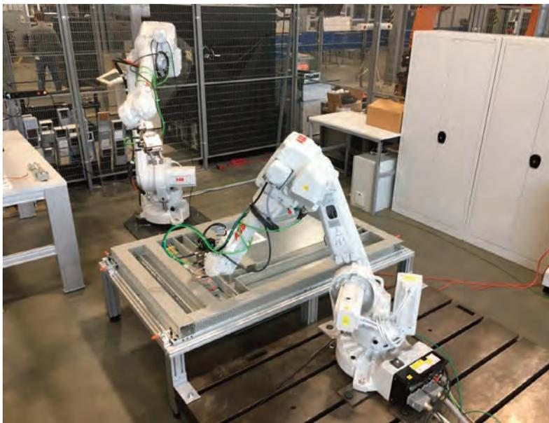
*Der innere Aufbau von Schaltschränken ist häufig sehr kundenspezifisch. Die daraus resultierende hohe Varianz und geringe Losgröße behindert in vielen Fällen eine effiziente Automatisierung. Ziel des Forschungsprojekts RoboSChalt an der Ruhr-Universität Bochum ist ein Konzept für die automatisierte Verdrahtung von Klemmen unter Nutzung eines Industrieroboters.*
