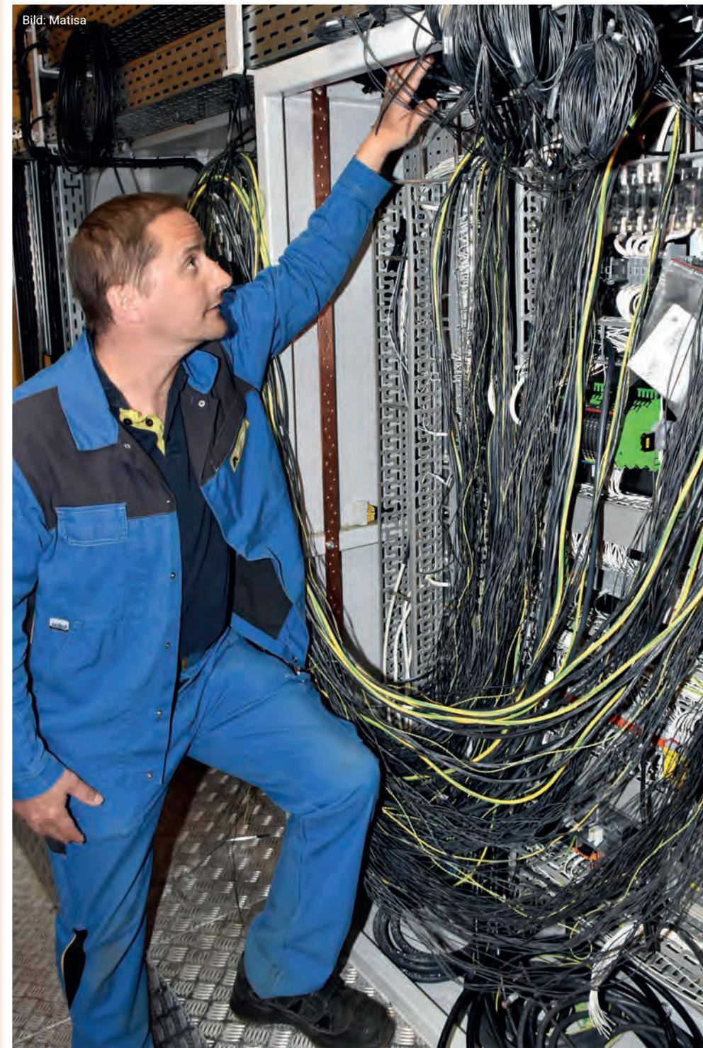
**Bild 3** | Elektriker Blaise Schopfer zeigt die aufwendige Verkabelung eines Zuges
