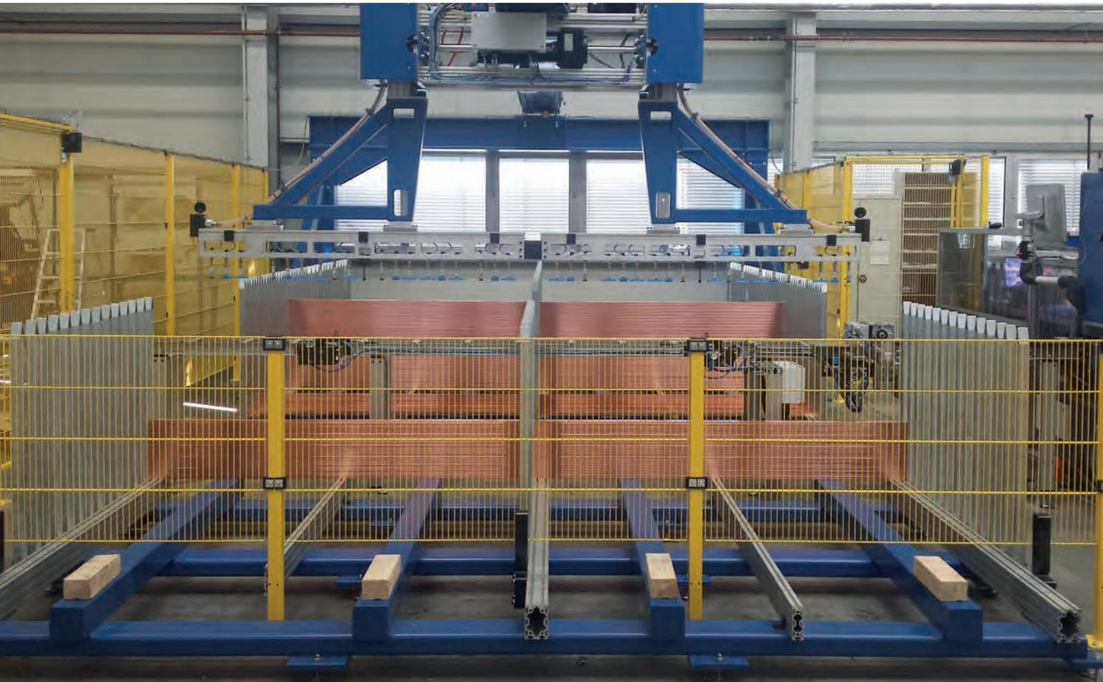
Bild 1 | Das Gantry und die Stanzmaschine arbeiten als ein Maschinensystem zusammen und übernehmen den gesamten Arbeitsprozess vollautomatisch.
