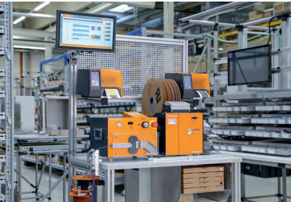
**Bild 3** | Die mitgelieferte Software steuert die Abarbeitung der Konfektionierungsschritte zwischen den Komponenten. In der Produktion werden lediglich angelegte Hilfskräfte benötigt.
