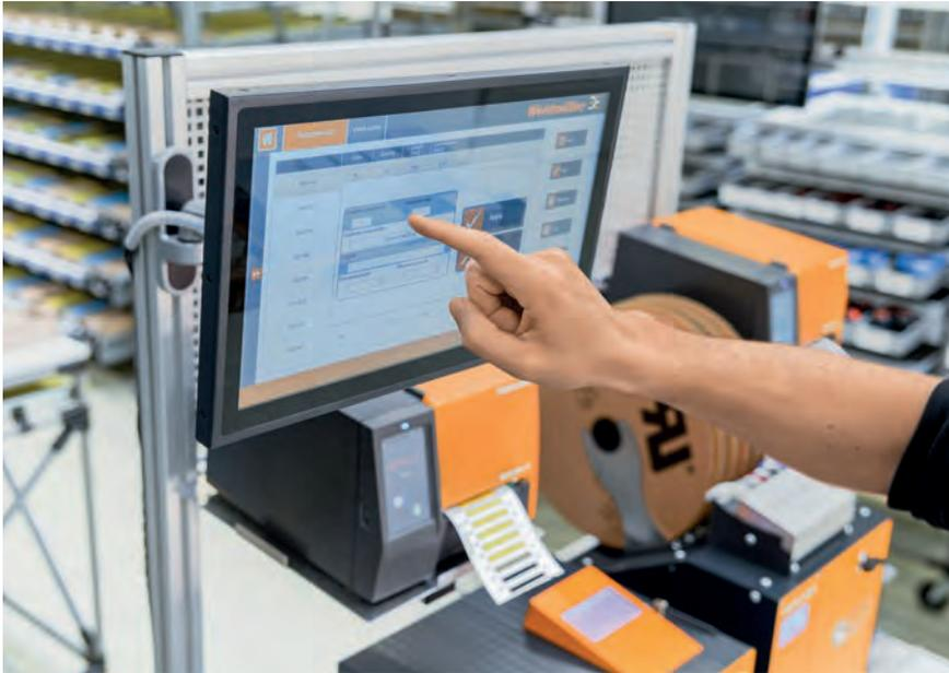
**Bild 4** | Die teilautomatisierte Kabelkonfektionierung beschleunigt den Prozess um bis zu 80 Prozent.
