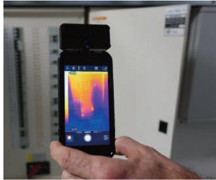
Bild 4 | Eine Überprüfung der Rack-Vorderseiten mit der Flir One Pro macht Bereiche mit zirkulierender Heißluft deutlich sichtbar.
