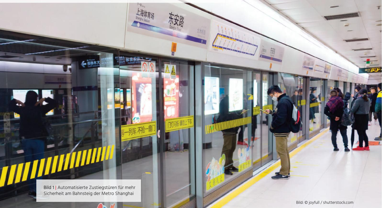
Bild 1 | Automatisierte Zustiegstüren für mehr Sicherheit am Bahnsteig der Metro Shanghai
