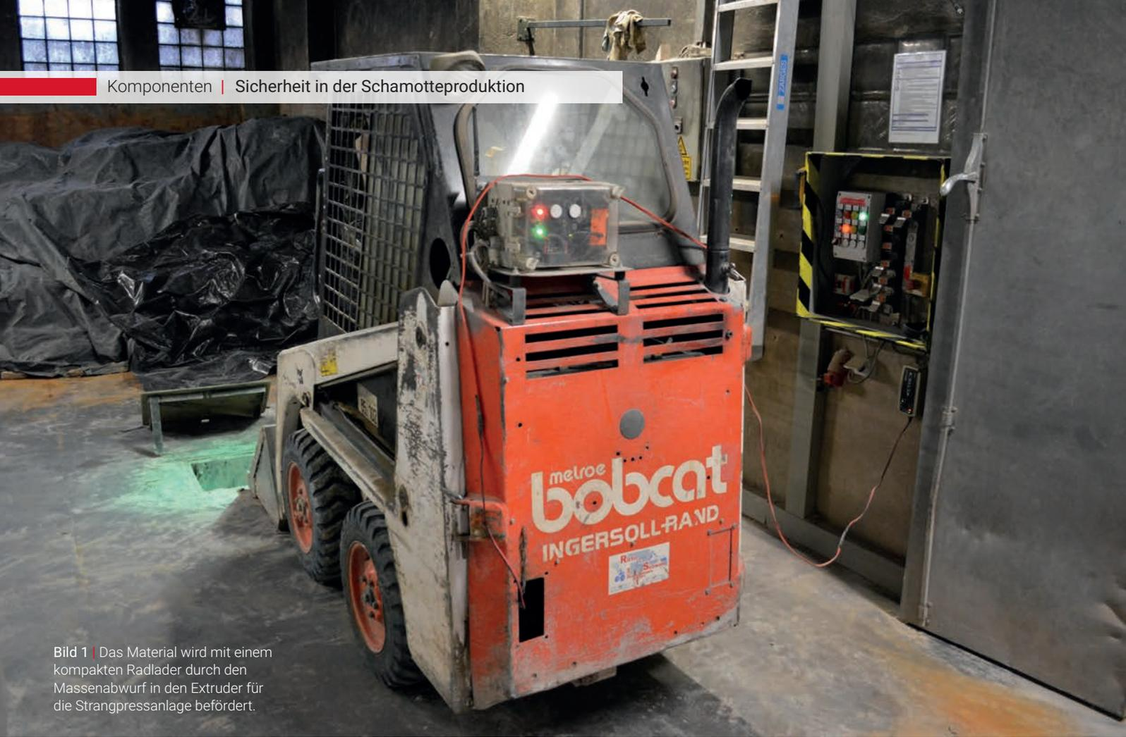
Bild 1 | Das Material wird mit einem kompakten Radlader durch den Massenabwurf in den Extruder für die Strangpressanlage befördert.
