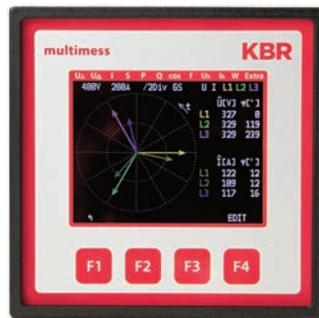
Bild 2 | Zeigerdiagramm der Ströme und Spannungen
