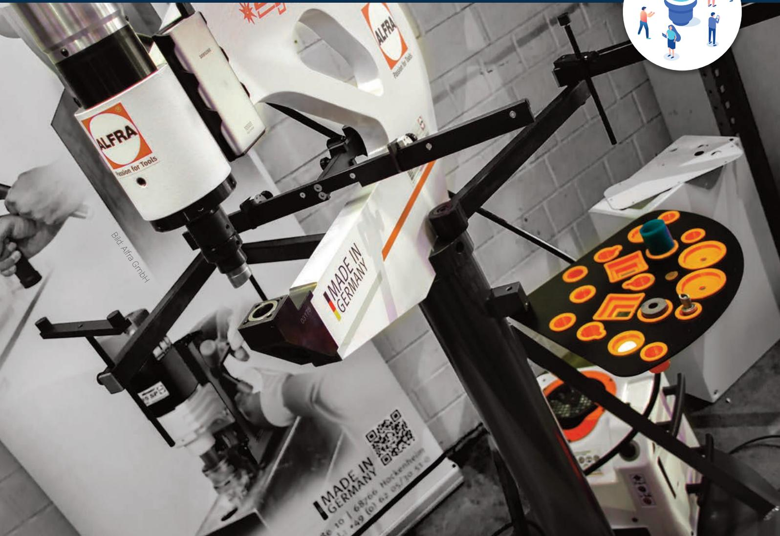
Bild 1 | Die mit den AP 250 und AP 400 benutzten Blechlocher treffen mit 46kN auf das Material.
