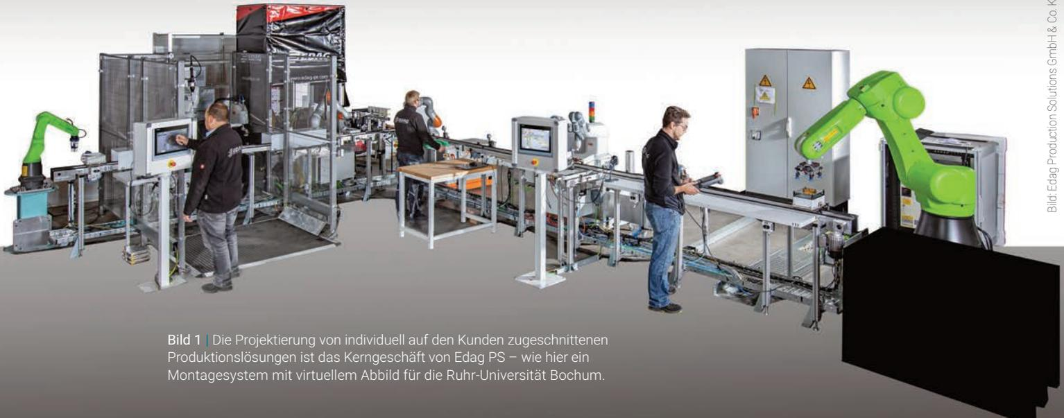
Bild 1 | Die Projektierung von individuell auf den Kunden zugeschnittenen Produktionslösungen ist das Kerngeschäft von Edag PS – wie hier ein Montagesystem mit virtuellem Abbild für die Ruhr-Universität Bochum.
