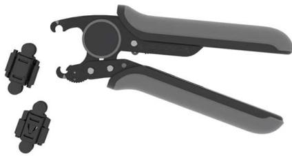
Die neuen, leicht zu betätigenden 360°-Crimpzangen von Conta-Clip sorgen für eine präzise und sichere Crimpung von Aderendhülsen nach DIN46228 EN50027. Die Zangen PZD 16/R und PZU 16/R werden mit Vierkant- bzw. Trapez-Crimpeinsatz geliefert. Die Einsätze lassen sich ohne Werkzeug schnell wechseln, und vor allem lassen sie sich um 360° verstellen mit Rastung in 45°-
