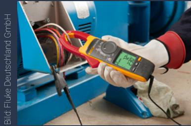
Die neuen Echteffektiv-Strommesszangen Fluke 377 und 378 für AC und DC machen die gleichzeitige Messung von Spannung und Strom sicherer und einfacher, ohne Kontakt zu einem stromführenden Leiter. Sie verwenden die FieldSense-Technologie, um Spannung und Strom mit der Stromzange zu erfassen, wobei nur ein Erdanschluss als Referenz benötigt wird. Beide Messgeräte sind als FC-Versionen mit Bluetooth-Schnittstelle erhältlich.
